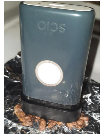
Figura 6. Apparecchio SCIO TM v1.2 che esamina i vinaccioli estratti da 10 acini per ottenere una valutazione rapida della Maturità Polifenolica (MP).
