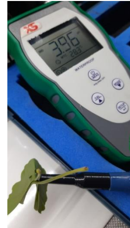
Figura 2. Elettrodo combinato Hamilton double pore PF , misuratore di fogliare.
