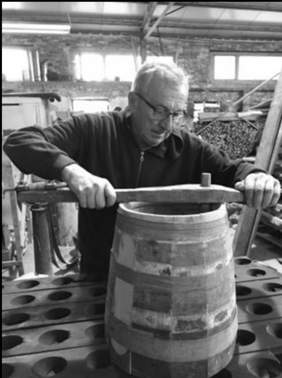
Intaglio manuale della capruggine (Laboratorio Luigi Ghione, Canelli, 2022)
