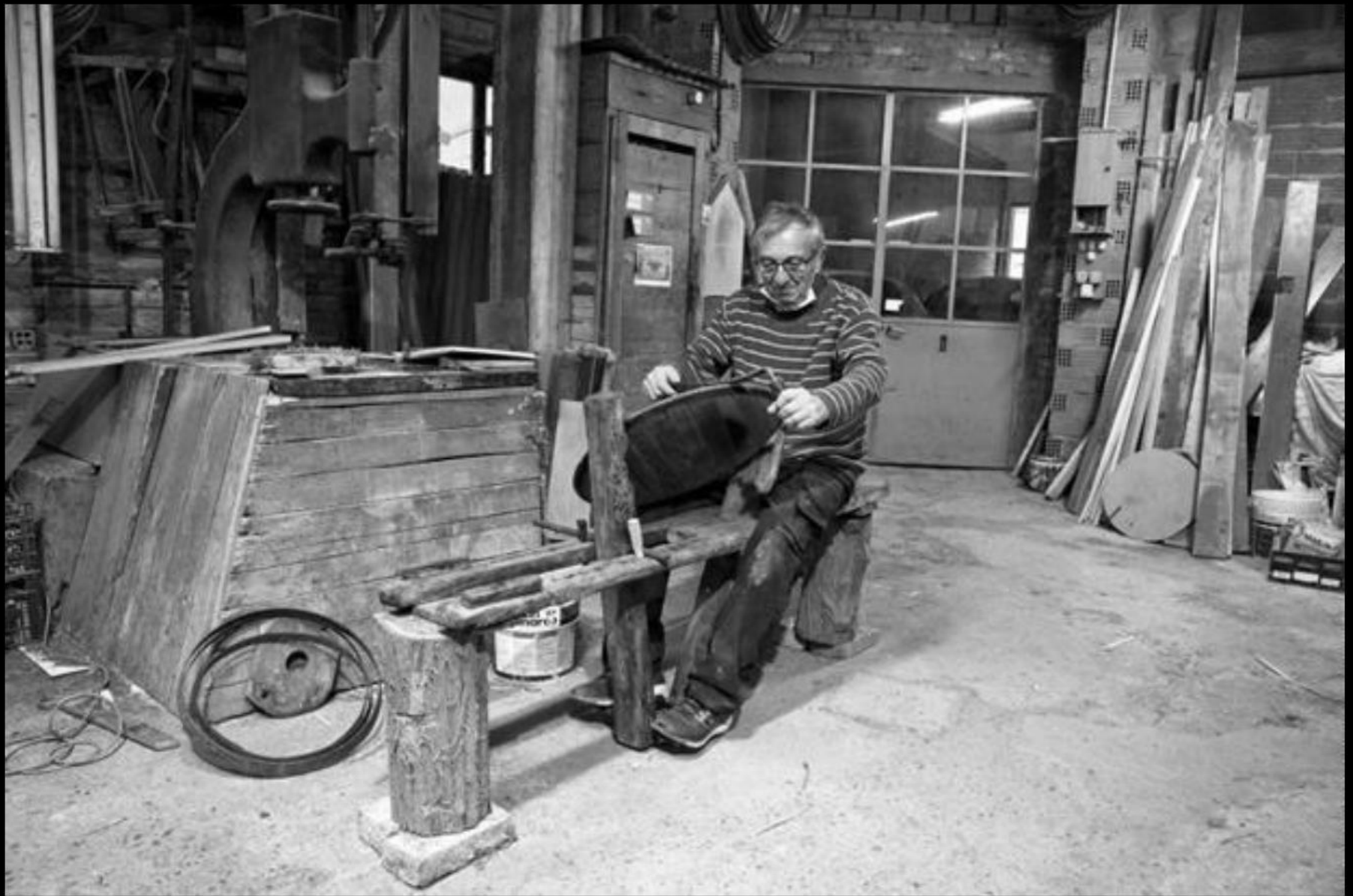
Fase di smussamento del fondo con il coltello a petto (Laboratorio Luigi Ghione, Foto Pier Sergio Bobbio, Canelli, 2022)
